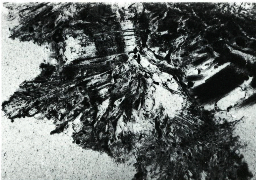
Abb. 23: Unzerstörtes Aggregat im Dünnschliff. Dunkler, faseriger Hydroxylapatit (rechts außen Mitte); umgeben von eng verwachsenem Brushit, größere Pakete mit gut entwickelter Spaltbarkeit nach (010). Länge des Maßstabes 200 \mu\text{m} .
